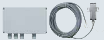
Récepteur relais 2 canaux HER 2 Avec 2 sorties de relais sans potentiel, fréquence 868 MHz, IP 65, tension de service 24 V CC / 230-240 V CA, antenne séparée pour l'extérieur (IP 65), dans boîtier aluminium antisabotage, ligne de raccordement de 7 m, à 3 fils, unité d'analyse pour l'intérieur
