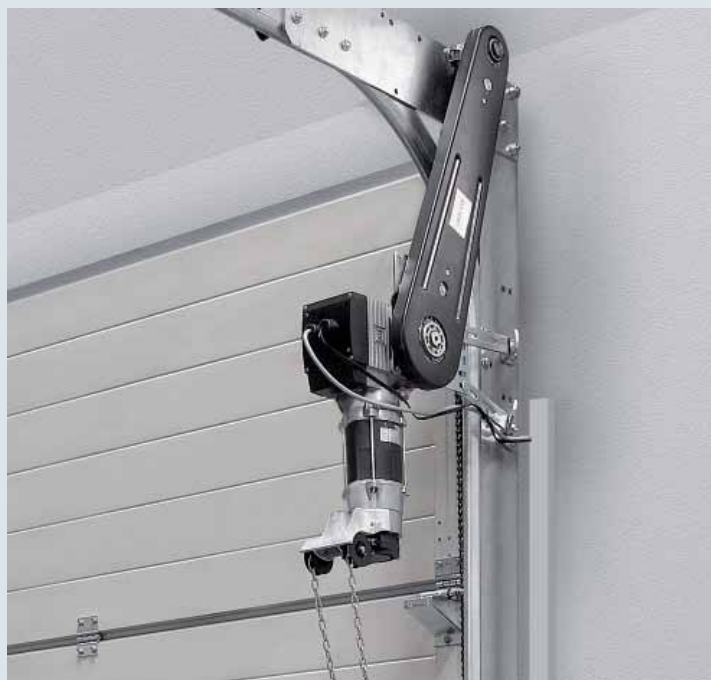
Position de montage standard verticale. Illustration avec chaîne manuelle de secours disponible en option.
